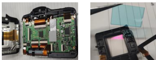
(a)分解の様子 (b)ホットミラーフィルタの除去
