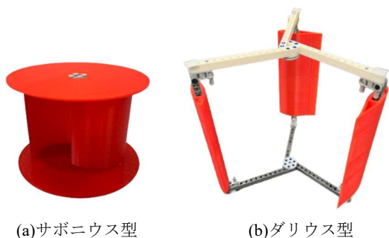
図3. 設計したサボニウス型風車とダリウス型風車
