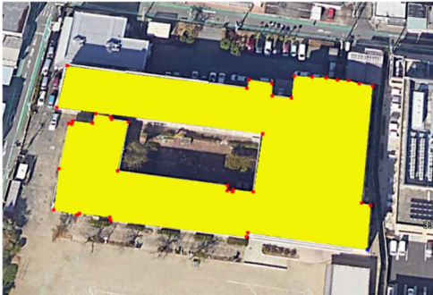
図2 マーキングによる屋根面積算出結果
