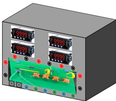
図1 教育用双方向昇降圧コンバータの完成イメージ
