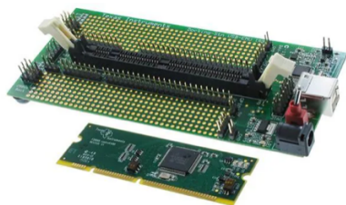
図 6.1.1 制御ボード (TMS320F28335)
