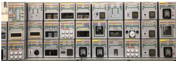
図1. 既存のモジュール型の電力系統トレーニング装置
