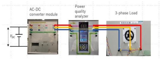
図 4 単独運転試験の配線図
