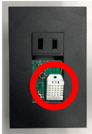
図7 スマートコンセント室温湿度センサー
