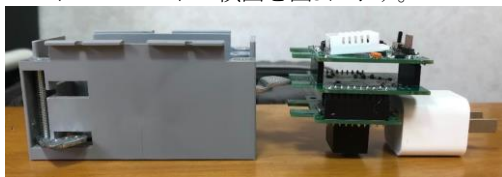
図5 スマートコンセント横図
